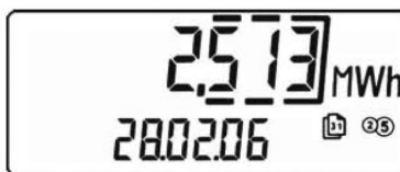
Exempel: månadsvärde värme energi
