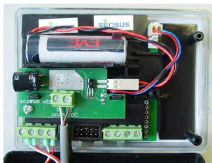
Fig. 5: Anslutningsexempel på temperaturgivare med tvåledar-teknik
