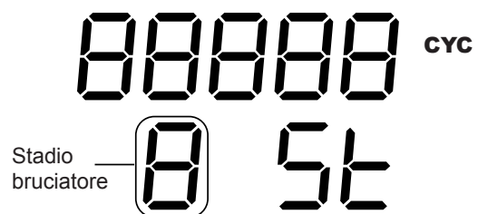
Cicli funzionamento in secondo stadio
