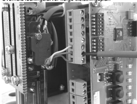
Tilslut tilbagemeldingspotentiometer Overhold ledningsfarver ifølge tilslutningsplan
