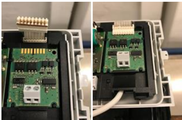
Figur 12: Montera M-Buskortet och anslut anslutningskontakten till M-Buskortet
